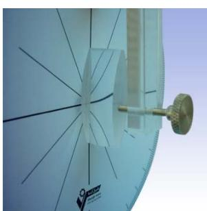
**ب- دیسک نوری :** این دیسک دارای یک پایه ثابت می باشد که می تواند بطور مستقیم روی لغزنه قرار بگیرد و یا توسط پایه L شکل روی لغزنه نصب شود.
