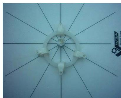
**۳- قرقره:** از یک پایه تشکیل شده است که روی میز قرار می گیرد و برای جابجا می شود. این قرقره ها بوسیله پیچ ثبیت روی میز محکم می شوند. روی پایه ها یک شاخص برای اندازه گیری زاویه طراحی شده است. محور قرقره از یک سطح صیقلی میکروسکوپی طراحی شده که دقت آزمایش را بالامی برداشت.
